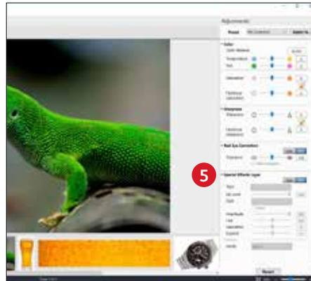
**5** I controlli per l'applicazione del toner trasparente come strato di effetti speciali si trovano nella parte inferiore del pannello **Regolazioni**.
